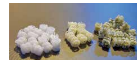
微生物寄居的Hel-x颗粒 (左-未使用过的生化球, 右-有微生物寄居)
